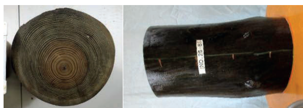
写真-1 86 年間以上橋脚基礎に使われ地下水位以下にあった丸太の写真（腐った様子は認められない）
