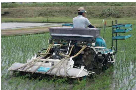
図 1 高精度水田用除草機による機械除草（左）および同機による米ぬか同時散布（右）
