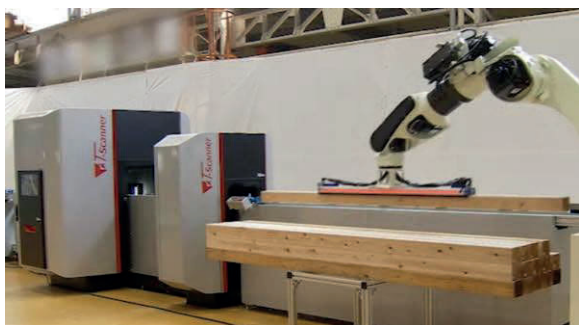
▲ ロボットアームを用いた選別作業
